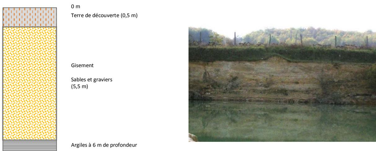
L'exploitation du gisement se fera jusqu'à atteindre le substratum marneux, qui se rencontre en moyenne à 6 m de profondeur et au maximum à 8-10 m de profondeur.
